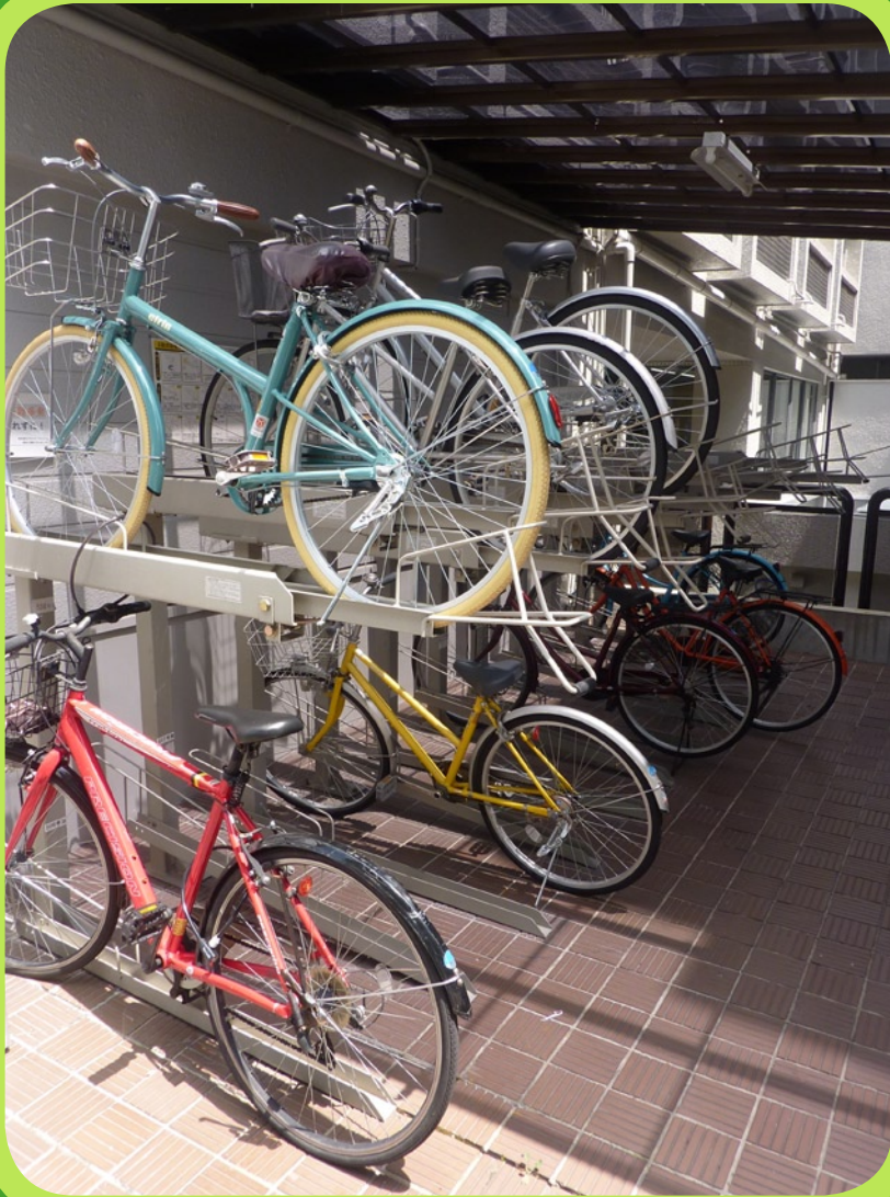
Parking vélo à deux étages, au rez-de-chaussée d'un immeuble, avec bras télescopique articulé pour faciliter l'installation.
